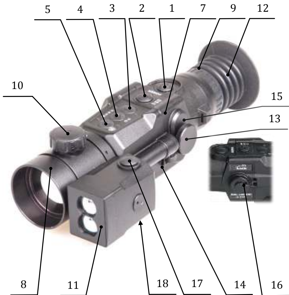
Рисунок 1 – Внешний вид прицела и органы управления
