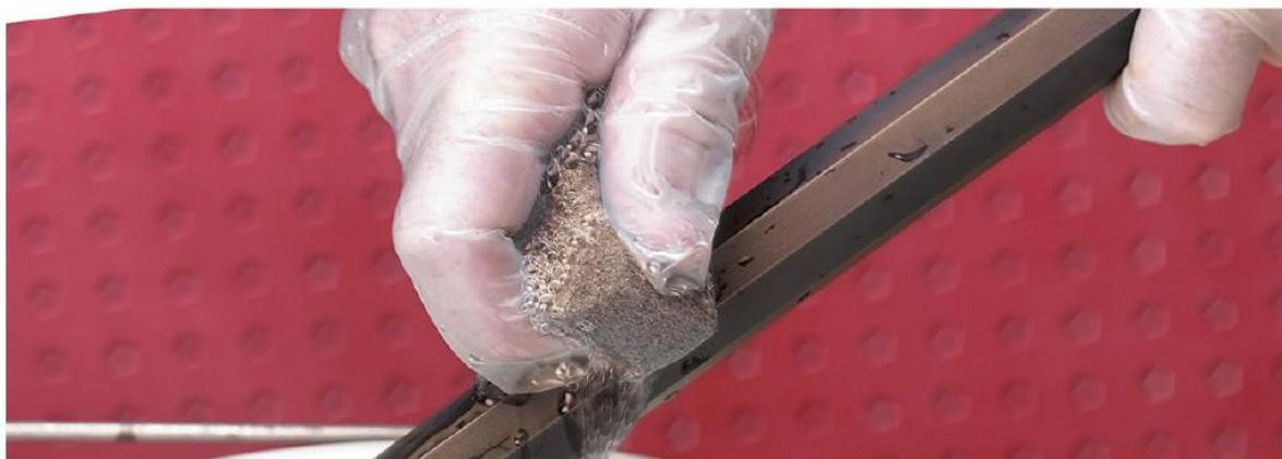
6. После завершения воронения протрите все поверхности средством Barricade Rust Protection. Это очень важно после промывки, средство проникнет на поверхность и обеспечивает глубокое, насыщенное, красно-коричневое равномерное покрытие. Выдержите средство в течение 24 часов.
