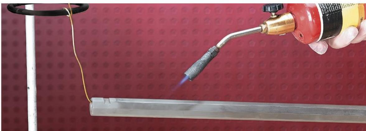
2. Равномерно нагревайте, перемещая источник тепла вперед и назад вдоль объекта, который подвергается воронению. Обратите внимание, что более тяжелые участки (например, казенник ствола) нагреваются и сохраняют тепло дольше. Кроме того, мелкие детали более подвержены перегреву. Поэтому нагревайте до 135 °С. Для контроля температуры, прочитайте Советы Кармишеля ниже. Необязательно нагревать весь ствол сразу. Можно нагревать и обрабатывать ствол частями.
